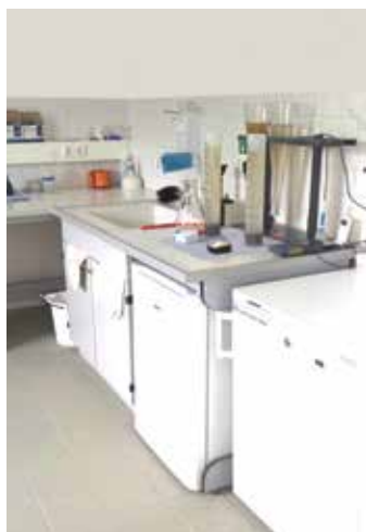
Nassbereich mit Verbund-Keramikplatte
