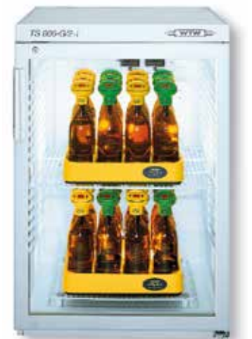
OxiTop Thermostatenschrank mit 2 x 12 Messstellen
